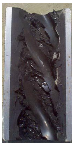
Рис. 1. Внешний вид резиновой обоймы, разрушенной вследствие высокого избыточного давления
