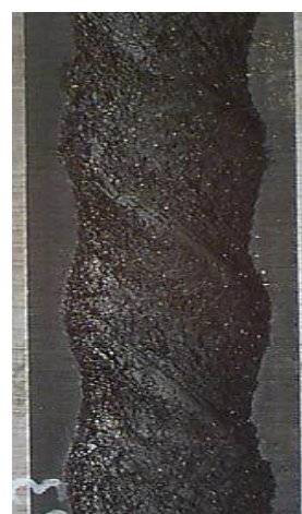
Рис. 2. Внешний вид обоймы, разрушенной вследствие воздействия ароматических соединений
