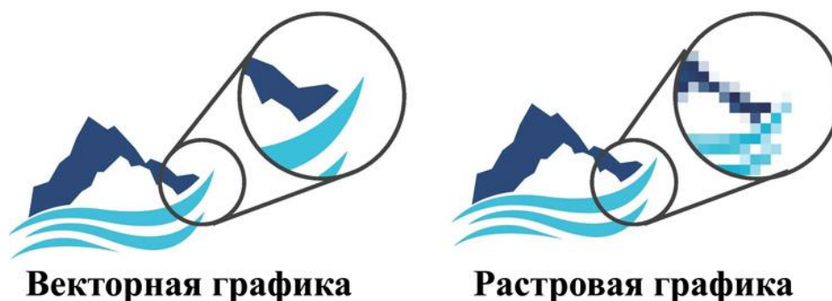
Рис. 2. Различия растровой и векторной графики
